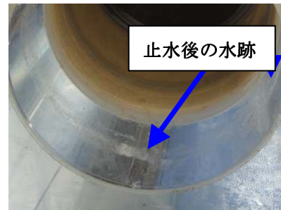
①. 水膨張ゴム装着 止水機能有
