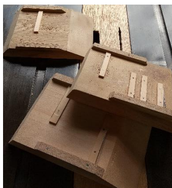
〈治具〉 部材の長さや角度に合わせ、 その都度、自分で型を作る。
